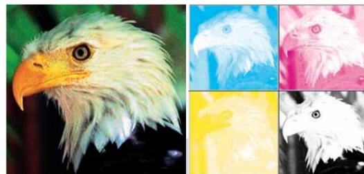
Illustration 7 : Composition exemplaire d'une image dans le système CMYK
