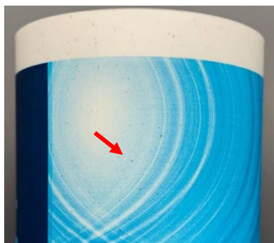
Illustration 6 : Résultat d'impression avec micro-taches
