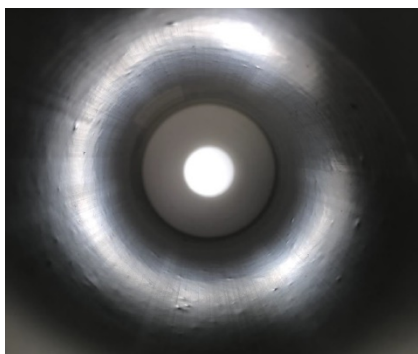
Illustration 9 : Paroi intérieure du tube avec bandes d'extrusion dans le sens du flux
