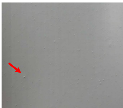
Illustration 5 : Paroi interne du tube, inclusion de particules visible
